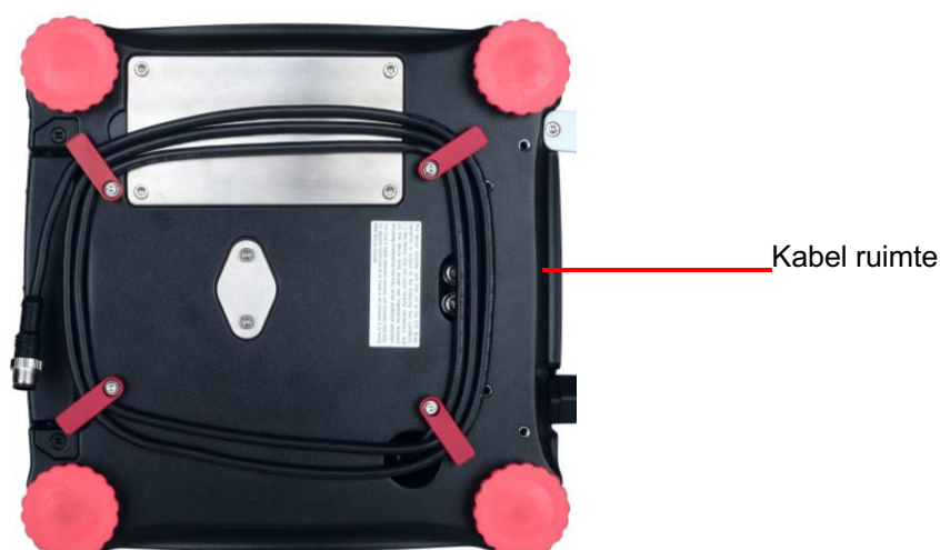
Schroefdraadklemkabel langs kabelspoelen aan de onderkant van de schaal. Of leid de kabel door de groef bij de ontspanknop.
